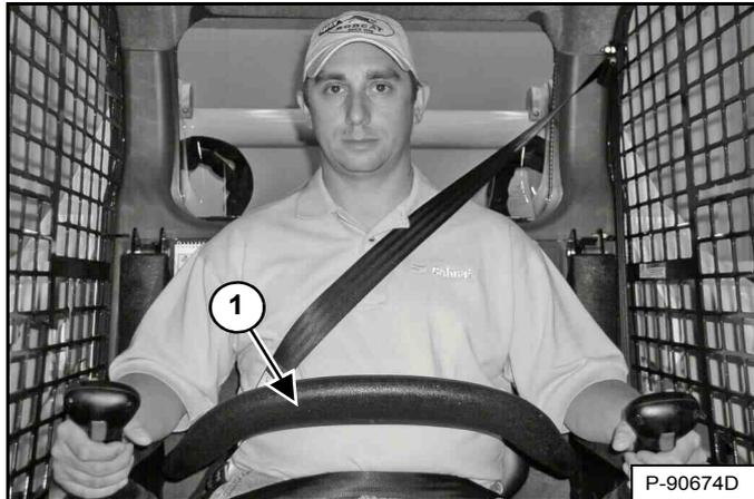
Le dispositif de sécurité de l'arceau de siège comprend un arceau de siège pivotant avec accoudoirs (1) [Figure 32].
