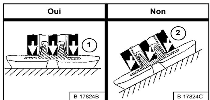
Les composants du système de traction s'usent plus vite en travers dans une pente. Sur une surface de niveau, le poids de la machine est réparti sur les chenilles par toute la surface des galets (1). En travers dans une pente, le poids porte sur le bord des galets et contre les dents de guidage des chenilles (2) [Figure 152], ce qui provoque une usure accrue.
