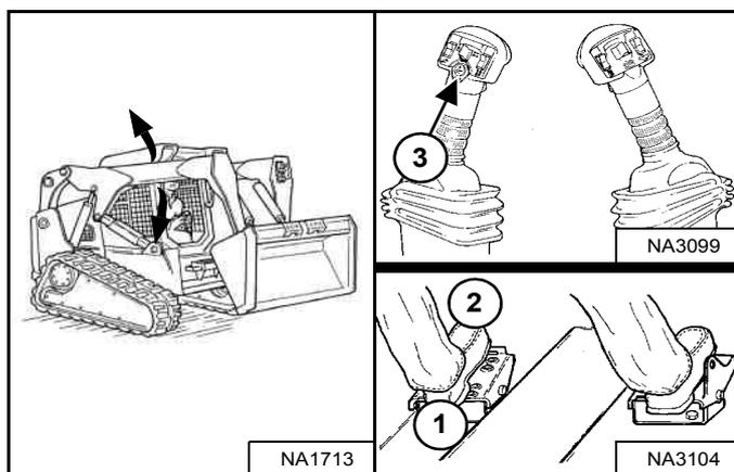
Position de flottement des bras de levage (avec système de commande ACS) – (Pédale gauche et poignée gauche)
