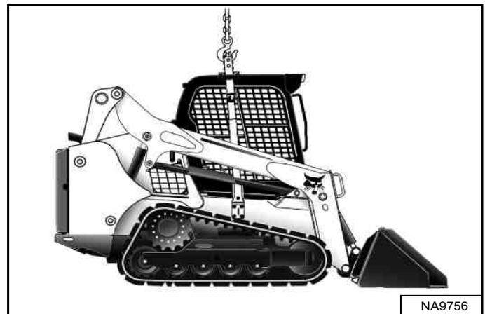
Fixez le crochet de levage au point de levage [Figure 159].
