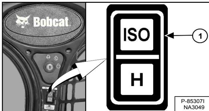
Sélectionnez le schéma de commande ISO en appuyant sur le haut du contacteur (1) [Figure 55].
