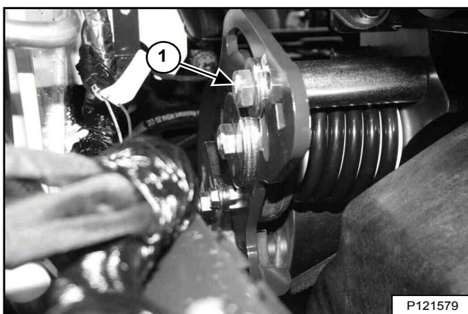
Desserrez le boulon de réglage (1) du tendeur à ressort [Figure 271].
