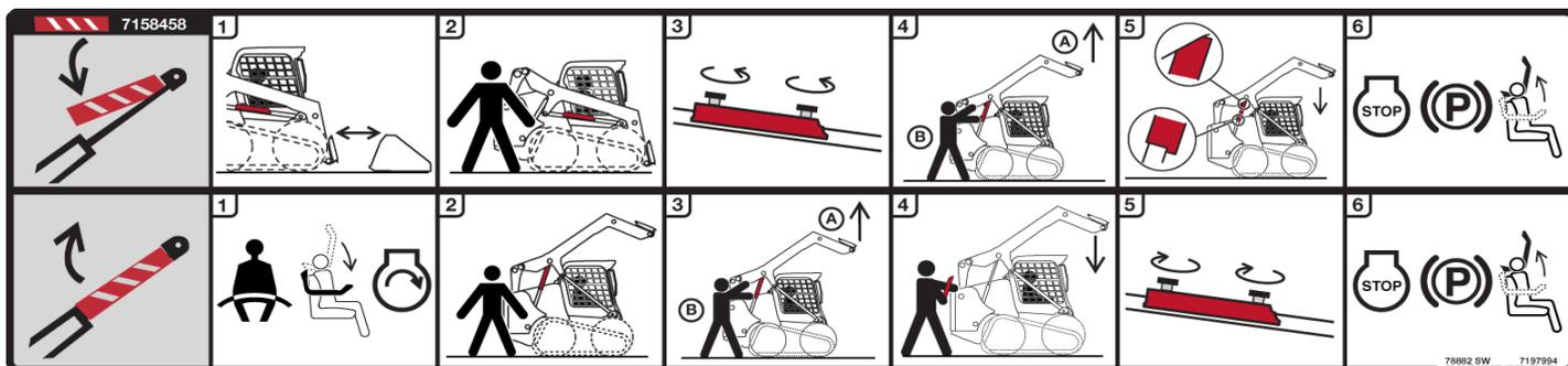
Installation de l'arrêt de bras de levage approuvé :
