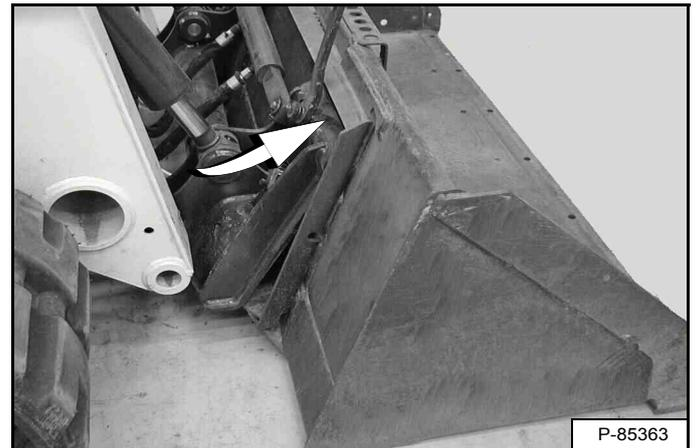
Avancez lentement la chargeuse jusqu'à ce que le bord supérieur du Bob-Tach soit complètement sous le gousset supérieur du châssis de fixation du godet [Figure 143] (ou autre accessoire).
