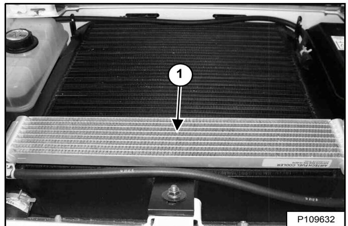
Nettoyez le dessus du refroidisseur de carburant (1) avec de l'air ou de l'eau à basse pression [Figure 216].
