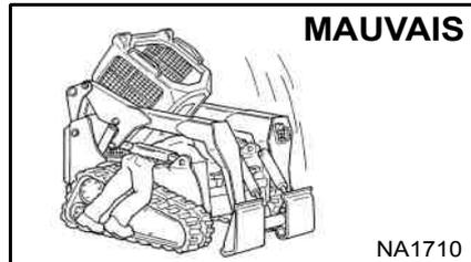
**!** Le débranchement ou le desserrage d'une conduite hydraulique, d'un flexible, d'un raccord, une pièce ou un composant défectueux peuvent provoquer la chute des bras de levage. Ne vous tenez jamais sous les bras de levage relevés s'ils ne sont pas maintenus par un arrêt de bras de levage approuvé. Remplacez-le en cas de détérioration.
