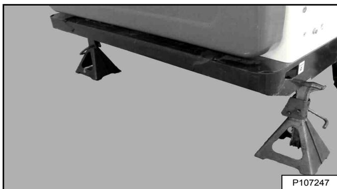
Placez des chandelles sous les coins arrière du châssis de la chargeuse [Figure 180].
