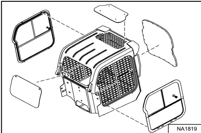
Destiné à éviter l'entrée de projections de débris et d'objets dans la cabine au cours de certains travaux. Ce kit comprend une vitre de porte avant, des vitres latérales et une vitre arrière de 19,1 mm (0,75") en polycarbonate feuilleté [Figure 5].
