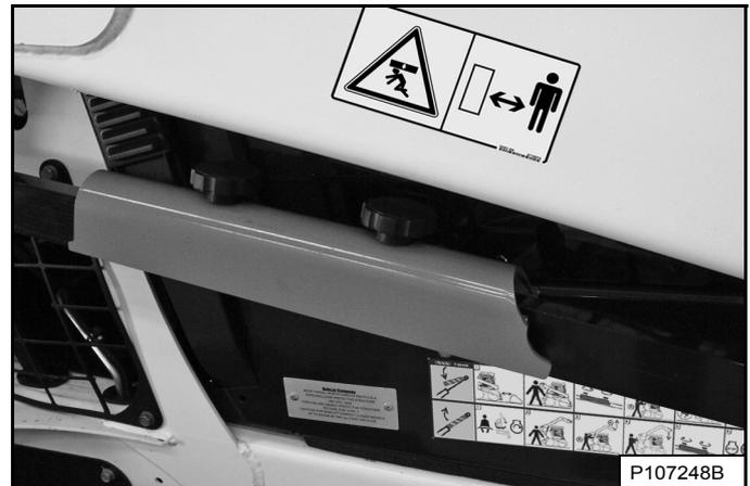
Placez l'arrêt de bras de levage dans sa position de rangement et fixez-le à l'aide des boutons de serrage [Figure 173].
