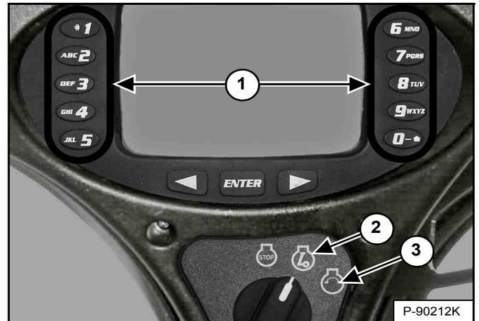
Tournez le contacteur à clé sur la position MARCHÉ (2). Les témoins du tableau de bord gauche s'ALLUMENT brièvement tandis que le tableau de bord/système de surveillance exécute un test automatique. Utilisez le pavé numérique (1) [Figure 124] pour saisir le mot de passe.
