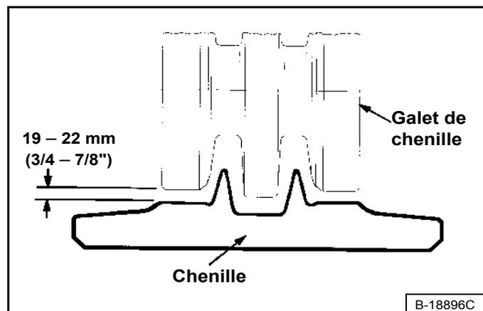
N'introduisez JAMAIS les doigts dans l'espace entre la chenille et le galet. Contrôlez l'espacement à l'aide d'une cale, d'une douille ou d'un boulon de 19 à 22 mm (3/4 à 7/8") [Figure 253] et [Figure 254].
