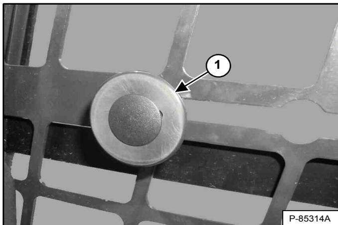
Tirez le bouton (1) [Figure 24] et ouvrez la vitre en la faisant coulisser vers l'arrière. Relâchez le bouton au niveau de la découpe pour verrouiller la vitre dans la position voulue. Tirez le bouton et faites coulisser la vitre vers l'avant pour la fermer.
