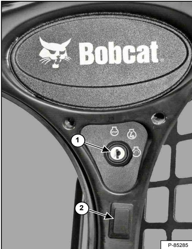
Cette machine peut être équipée d'un tableau standard à contacteur à clé [Figure 13].
