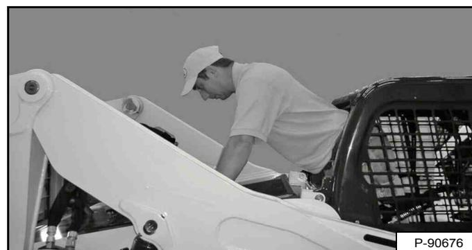
Sortez de la chargeuse par l'arrière de la cabine [Figure 43].
