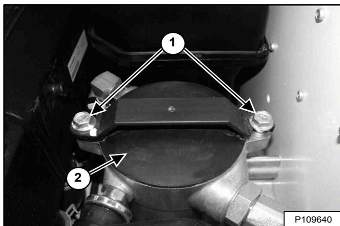
Desserrez les boulons (1) et tournez le bouchon du filtre (2) [Figure 246] vers la gauche jusqu'à soulever les boulons.
