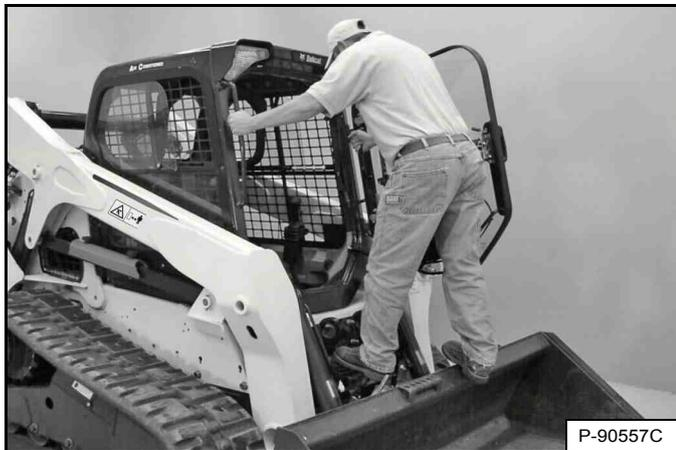
Utilisez les marchepieds du godet ou de l'accessoire, les mains courantes et l'antidérapant (sur les bras de levage et le châssis de la chargeuse) pour monter et descendre de la chargeuse en maintenant en permanence un contact en trois points [Figure 103]. Ne sautez pas.
