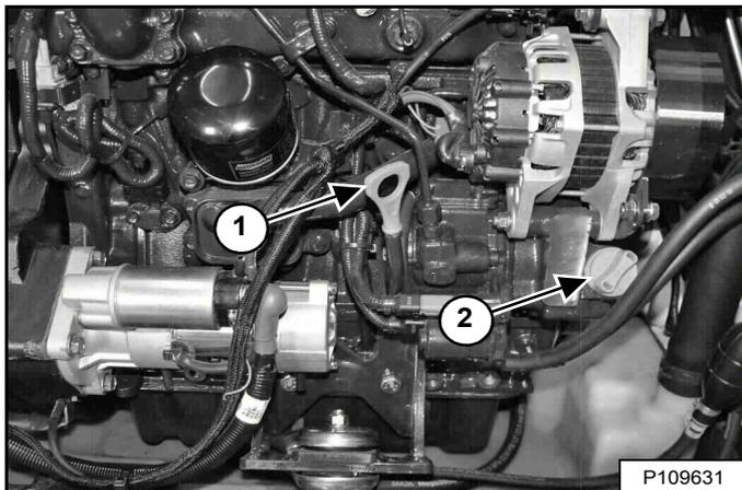
Stationnez la chargeuse sur une surface plane et de niveau. Arrêtez le moteur. Ouvrez la porte arrière et tirez la jauge (1) [Figure 209].
