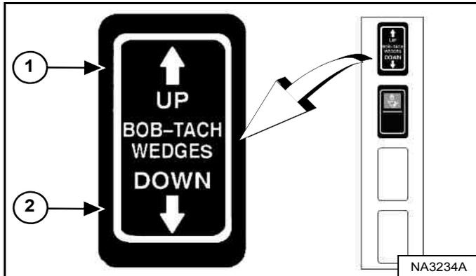
Enfoncez et maintenez le côté UP du contacteur BOB-TACH WEDGES (montée des broches coniques) (1) jusqu'à ce que les broches coniques soient complètement relevées. Enfoncez le côté DOWN du contacteur BOB-TACH WEDGES (descente des broches coniques) (2) et maintenez-le dans cette position [Figure 295] jusqu'à ce que les broches coniques soient complètement abaissées.
