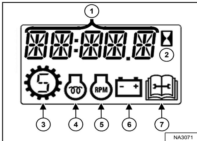
L'affichage est représenté en [Figure 12]. Au démarrage, l'affichage des données indique les heures de fonctionnement.
