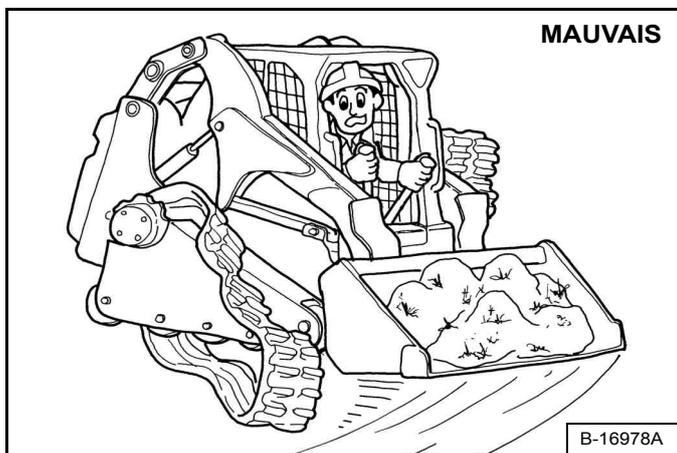
**Virages :** sur l'asphalte ou le béton, utilisez le virage progressif (un levier plus en avant que l'autre) plutôt que le virage rapide (un levier en avant et l'autre en arrière) pour éviter d'user prématurément les chenilles ou de les faire décheniller [Figure 150].
