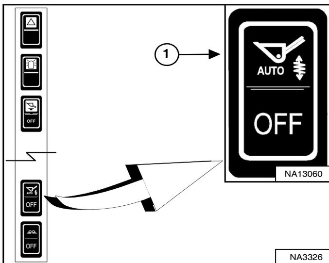
Appuyez sur le haut du contacteur du système antitangage automatique (1) [Figure 82] sur le panneau de contacteurs gauche pour activer la fonction d'antitangage automatique.
