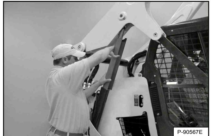
Demandez à une seconde personne de placer l'arrêt de bras de levage sur la tige de l'un des vérins de levage [Figure 170].
