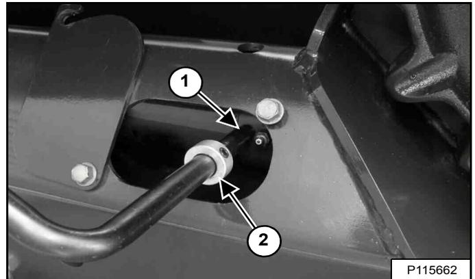
Installez l'outil purgeur (6675936) sur le raccord purgeur (1), réglez et serrez le collier (2) [Figure 256] de sorte qu'il se place derrière le bord du capot d'accès.
