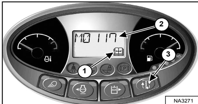
Remplacez les filtres à air uniquement lorsque cela s'avère nécessaire. Le témoin d'entretien (1) CLIGNOTE. Appuyez sur le bouton Information (3) jusqu'à ce que l'écran affiche les codes de service. Le code de service **[M0117]** (filtre à air colmaté) s'affiche (2) **[Figure 199]** lorsque le filtre doit être remplacé.
