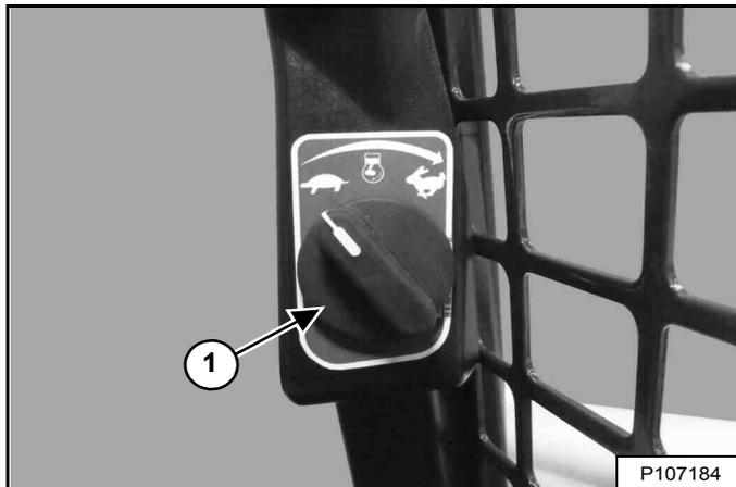
La commande d'accélérateur (1) [Figure 35] se trouve sur le montant de la porte, sous le tableau de bord droit.
