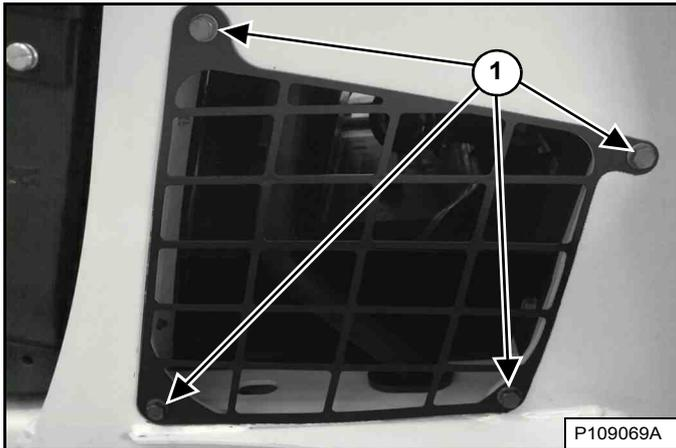
Déposez les boulons (1) du capot d'accès gauche [Figure 248] et retirez le capot (les bras de levage sont représentés levés pour plus de clarté).
