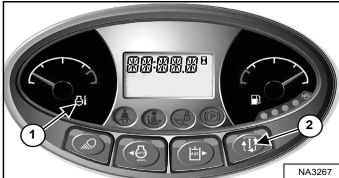
Contrôlez régulièrement les cadrans de température et de niveau de carburant ainsi que les témoins BICS™ (tous doivent être ÉTEINTS pour utiliser la chargeuse) [Figure 129].
