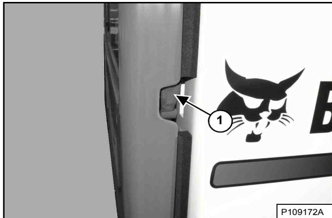
Passez la main dans l'encoche sur le côté droit de la porte arrière et tirez le loquet (1) [Figure 185]. Ouvrez la porte arrière en tirant dessus.
