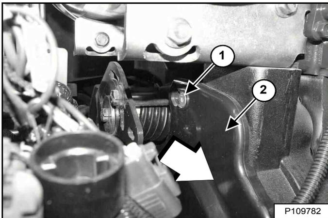
Ne desserrez **PAS** les boulons de fixation du capot de la courroie d'entraînement (boulon du haut représenté) (1). Faites glisser le capot de la courroie d'entraînement (2) [Figure 274] vers l'arrière de la chargeuse pour libérer le capot des vis de fixation inférieure et supérieure.
