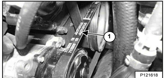
Coupez la courroie usagée (1) [Figure 268] et retirez-la des poulies. Contrôlez l'usure des poulies.
