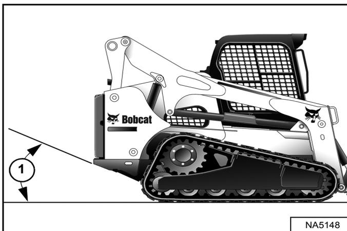
**REMARQUE :** la chargeuse doit être levée autant que possible à l'horizontale, mais l'angle de la chargeuse suspendue ne doit en aucun cas dépasser l'angle de dégagement (1) [Figure 160] indiqué dans les caractéristiques techniques. (voir Dimensions, page 208).
