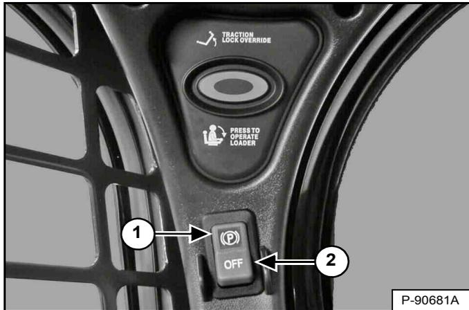
Enclenchez le frein de stationnement en appuyant sur le haut du contacteur (1) [Figure 33]. Le témoin rouge du contacteur S'ALLUME. La transmission est verrouillée.
