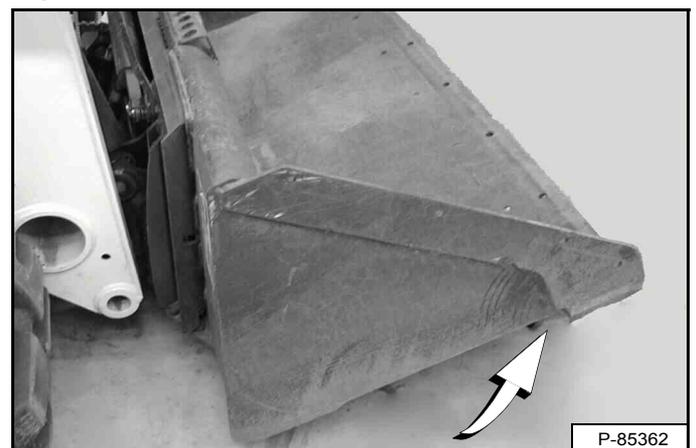
Inclinez le Bob-Tach vers l'arrière jusqu'à ce que le bord d'attaque du godet (ou autre accessoire) décolle légèrement du sol [Figure 144]. Cette procédure permet au châssis de fixation du godet de se plaquer contre l'avant du Bob-Tach.
