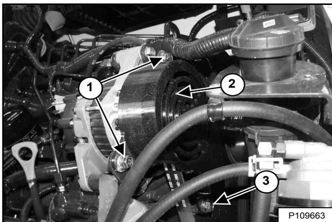
Déposez les boulons et les écrous de fixation du capot de la courroie d'entraînement (1). Dévissez le boulon de fixation (3) [Figure 263].
