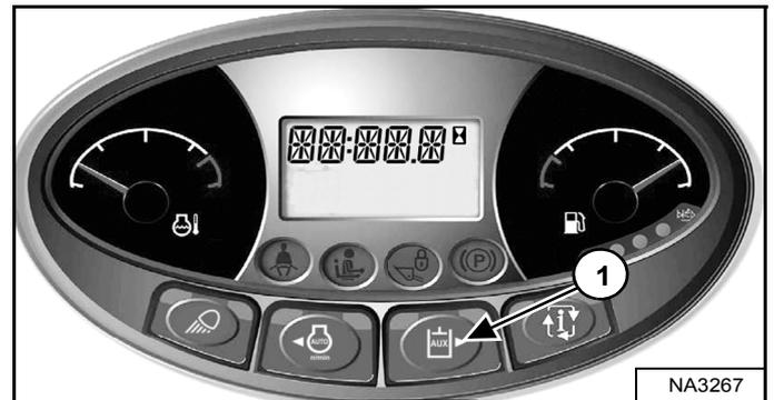
Appuyez sur le bouton du circuit hydraulique auxiliaire (1) [Figure 95].
