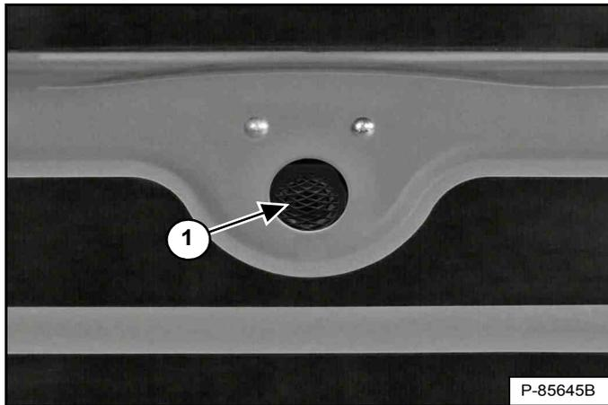
L'alarme de recul (1) [Figure 52] est située à l'intérieur de la porte arrière.
