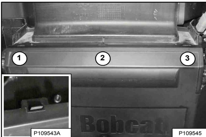
2. Poussez le capot vers le haut aux trois emplacements indiqués (1, 2 et 3) jusqu'à ce que les logements s'emboîtent sur les ergots. Ce logement (en médaillon) [Figure 197] est correctement fixé.
