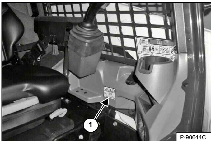
Assurez-vous que l'autocollant d'alarme de recul (1) n'est ni endommagé ni manquant [Figure 174]. Remplacez-le si nécessaire.
