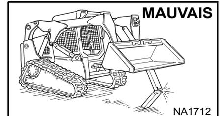
**!** Ne travaillez jamais sur la chargeuse avec les bras de levage relevés, à moins qu'ils ne soient maintenus par un arrêt de bras de levage approuvé. Remplacez-le en cas de détérioration. Ne modifiez jamais l'équipement et n'ajoutez jamais d'accessoires qui ne sont pas approuvés par Bobcat.
