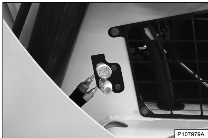
Déplacez le contacteur du circuit hydraulique auxiliaire arrière (1) [Figure 90] ou [Figure 91] vers la droite ou vers la gauche pour inverser le débit d'huile des raccords rapides arrière [Figure 92] (EXEMPLE : montée et descente des stabilisateurs arrière). Relâchez le contacteur pour arrêter le débit d'huile.
