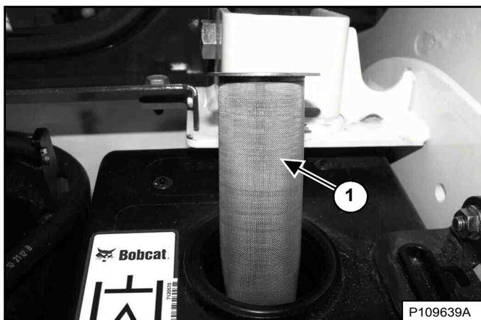
Déposez et nettoyez la crépine de remplissage d'huile hydraulique (1) [Figure 245]. Nettoyez la crépine avec de l'air à basse pression.
