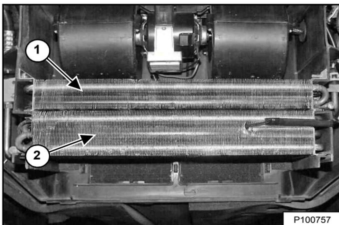
Nettoyez le faisceau de chauffage (1) et d'évaporation (2) avec de l'eau ou de l'air à basse pression pour retirer tous les débris [Figure 193].
