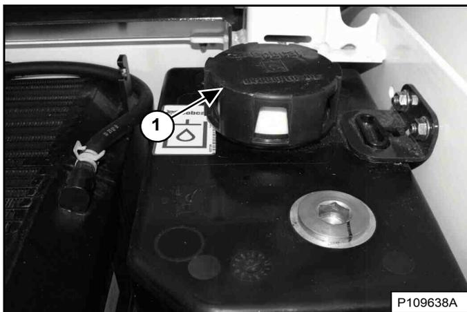
Déposez le bouchon de remplissage (1) [Figure 242].
