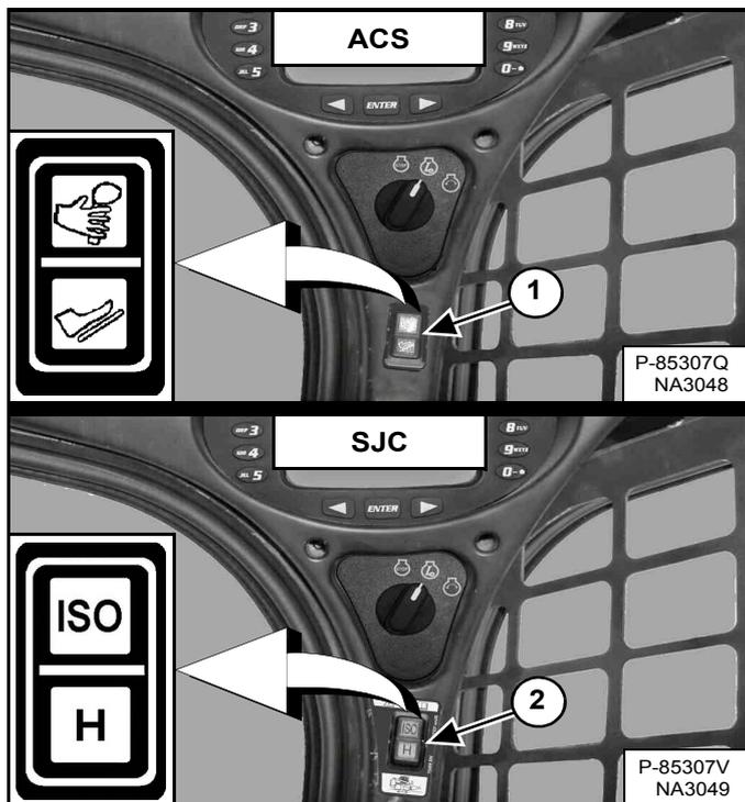
(ACS) Sélectionnez le fonctionnement par commandes manuelles ou par pédales (1) [Figure 126] si la machine est équipée de commandes ACS.
