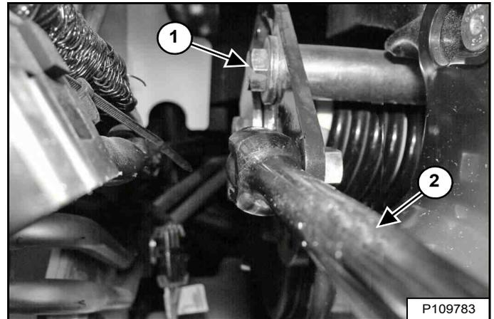
Desserrez le boulon de réglage (1) du tendeur à ressort. Insérez une poignée articulée (2) [Figure 275] dans le levier d'arrêt comme indiqué et appuyez sur la poignée pour libérer la tension de la courroie d'entraînement.
