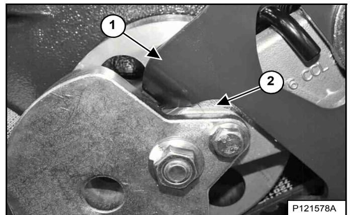
Laissez le bras d'arrêt (1) entrer en contact avec la partie supérieure du tendeur à ressort (2) [Figure 272].
