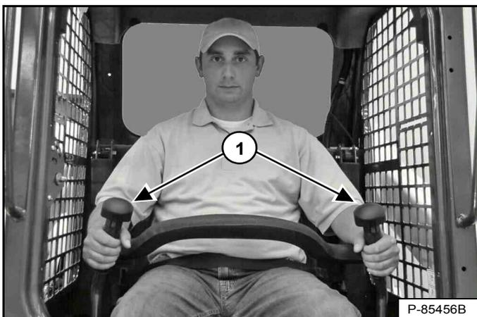
Les leviers de direction (1) [Figure 53] se trouvent à droite et à gauche à l'avant du siège.
