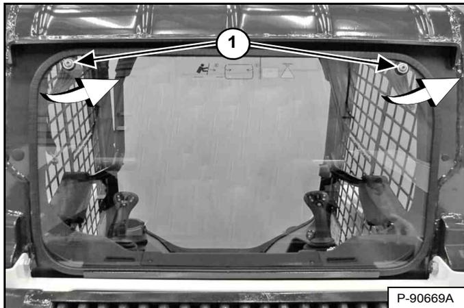
La vitre arrière peut être retirée depuis l'extérieur de la chargeuse à l'aide d'un tournevis T40 TORX®. Tournez chaque vis (1) [Figure 44] dans le sens anti-horaire jusqu'à ce que les loquets se dégagent du cadre de la vitre. Tirez le haut de la vitre vers l'extérieur et soulevez la vitre pour la retirer.
