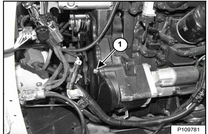
Serrez la vis (1) du capot de la courroie d'entraînement [Figure 278].
