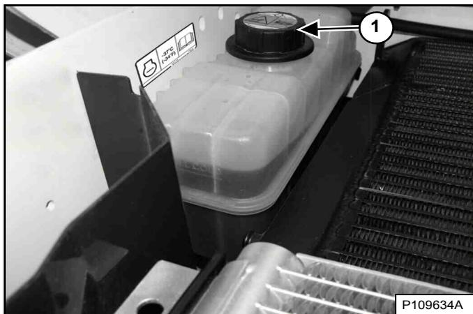
Déposez le bouchon de remplissage de liquide de refroidissement (1) [Figure 223].
