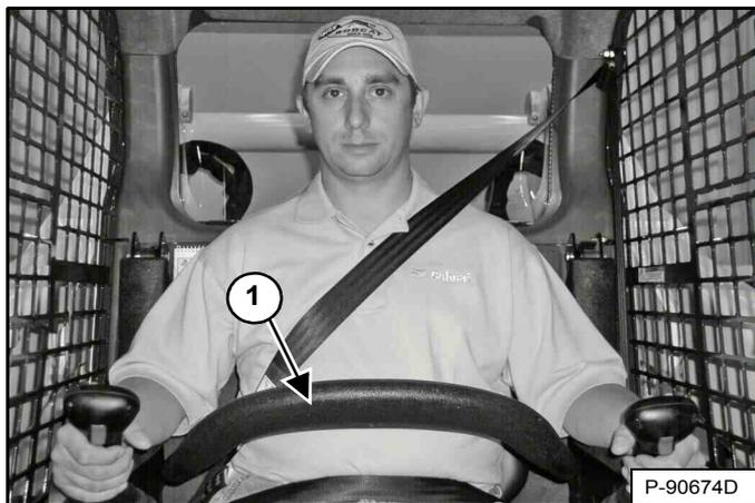
Le dispositif de verrouillage Bobcat (BICS™) comprend un arceau de siège pivotant avec accoudoirs (1) [Figure 30]. L'utilisation de l'arceau de siège est commandée par l'opérateur.
