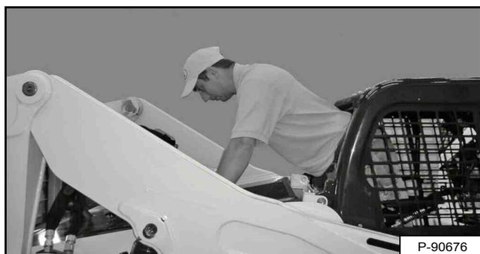
Sortez de la chargeuse par l'arrière de la cabine [Figure 41].
