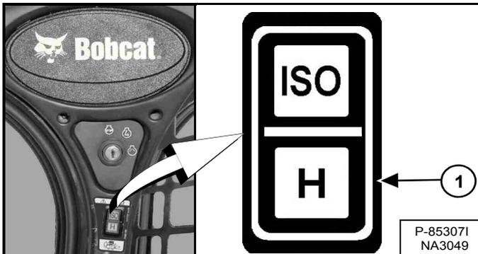
Sélectionnez le schéma de commande H en appuyant sur le bas du contacteur (1) [Figure 58].
