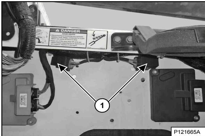
Deux relais supplémentaires (1) [Figure 234] correspondant aux feux avant sont situés sous la cabine de l'opérateur, du côté gauche de la chargeuse. Arrêtez le moteur et relevez la cabine de l'opérateur pour accéder aux relais (voir Levage, page 136).
