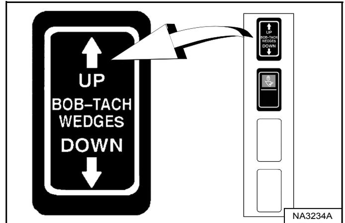
Appuyez sur le côté UP du contacteur BOB-TACH WEDGES (broches coniques vers le haut) (panneau de contacteurs droit) et maintenez-le enfoncé [Figure 148] jusqu'à ce que les leviers soient complètement engagés (broches coniques complètement relevées).
