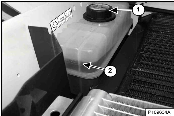
Le niveau du liquide de refroidissement doit être entre les deux repères Mini et Maxi (2) [Figure 222] lorsque le moteur est froid.
