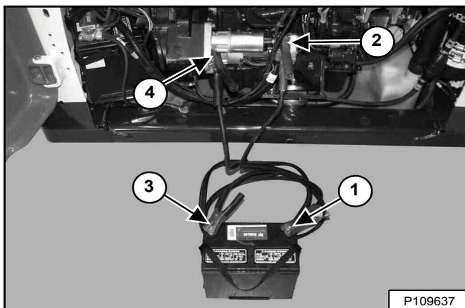
Raccordez une extrémité du premier câble (1) à la borne positive (+) de la batterie d'appoint. Raccordez l'autre extrémité de ce câble (2) [Figure 236] à la borne positive (+) du démarreur du moteur.
