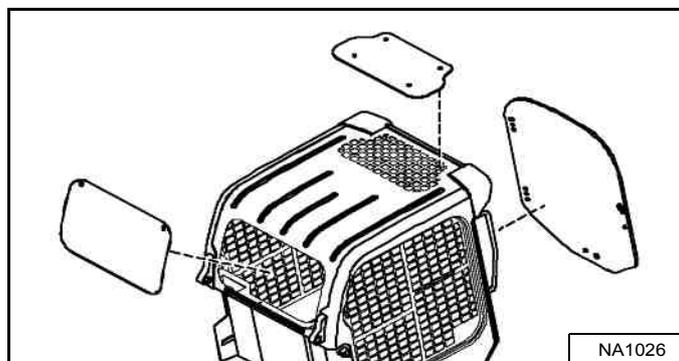
Destiné à éviter la pénétration de débris par les ouvertures de la cabine au cours de certains travaux. Ce kit comprend une vitre de porte avant et une vitre arrière de 12,7 mm (0,5") en polycarbonate **[Figure 4]**.
