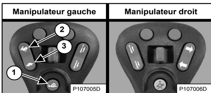
Appuyez une fois sur le bouton (1) [Figure 64] du manipulateur gauche pour activer la commande de gestion de la vitesse.
