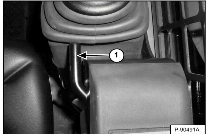
Tirez le levier de réglage (1) [Figure 112] des manipulateurs vers le haut pour faire glisser les manipulateurs vers l'avant ou l'arrière afin de les placer dans la position la plus confortable. (côté droit illustré).
