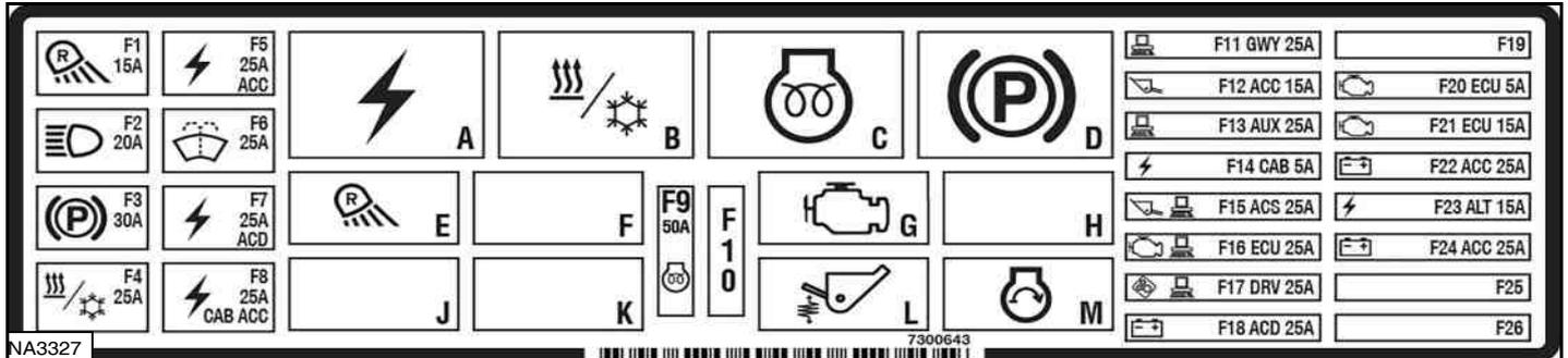
Le tableau ci-dessous correspond aux modèles récents avec l'autocollant réf. 7300643. Les emplacements et les ampérages des fusibles sont indiqués dans le tableau ci-dessous et sur l'autocollant [Figure 233]. Les relais sont identifiés par la lettre « R » dans la colonne AMP.
