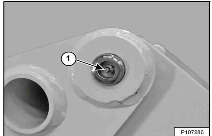
1. Axe pivot des bras de levage (des deux côtés) (2) [Figure 280].
