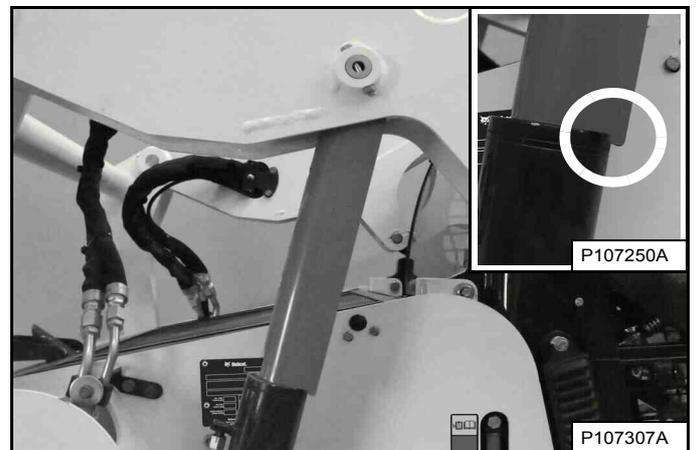
Abaissez lentement les bras de levage jusqu'à ce que l'arrêt de bras de levage soit maintenu entre les bras et le vérin de levage. Les ergots de l'arrêt de bras de levage doivent dépasser l'extrémité du vérin (voir médaillon) [Figure 171].
