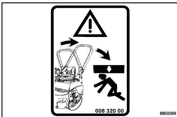
Fig. 10 Plaque d'avertissement - Arceau de sécurité ROPS rabattable 1
