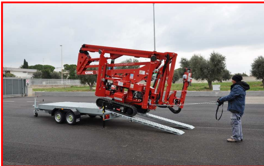
Figure 13 : chargement / déchargement à l'aide d'une rampe.
