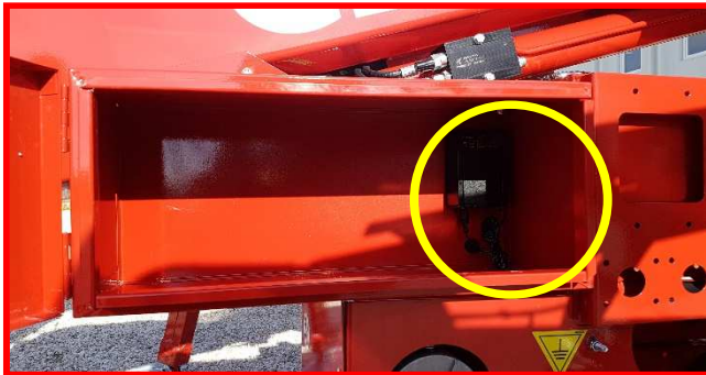
Figure 10 : chargement de la pile de radiocommande.
