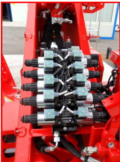
Figure 15 : banc vanne poste d'urgence.
