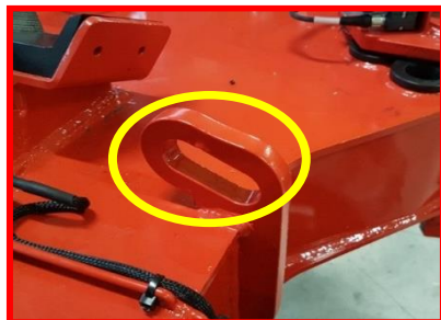
Figure 16 : crochets sur le châssis pour élinguer la PEMP.
