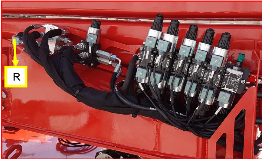
Figure 23b : banc d'urgence sur la tourelle si PEMP équipé d'une limiteur de moment (* en option).
