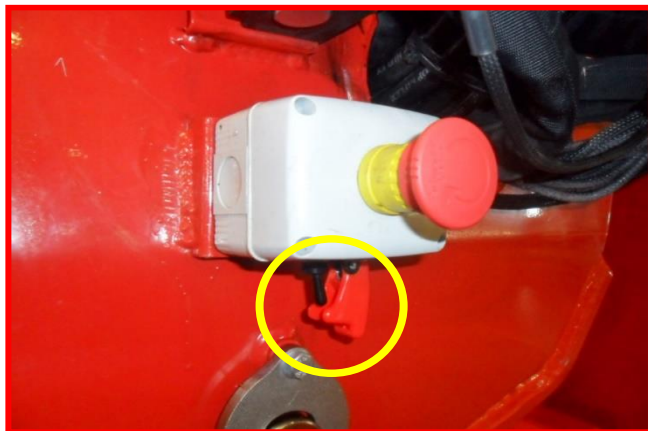
Figure 45 : bouton de by-pass de blocage de translation.
