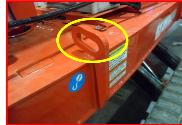
Figure 41 : crochets sur le châssis.
