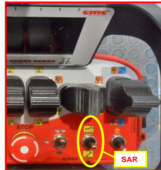
Figure 48 : sélecteur stabilisation/déstabilisation automatique sur radiocommande.
