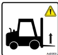
Figure 97 : indication des points d'enfourchement.
