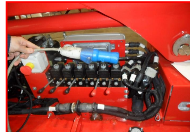
Figure 8 : branchement à la prise 120/230 V.
