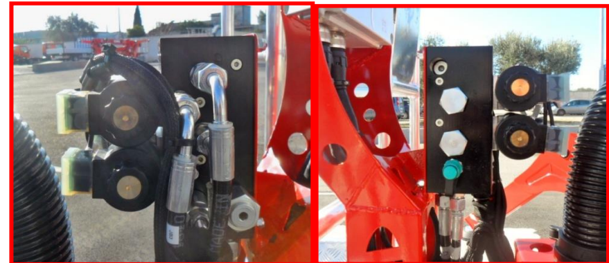
Figure 55 : vues côté machine gauche/droite du banc des curseurs pour la mise à niveau et la rotation.
