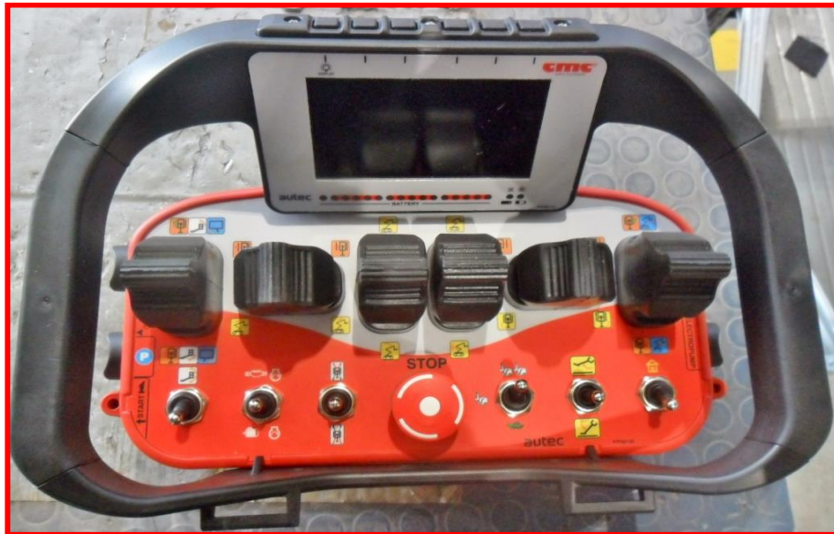
Figure 13 : poste AUTECH radiocommande plateforme.
