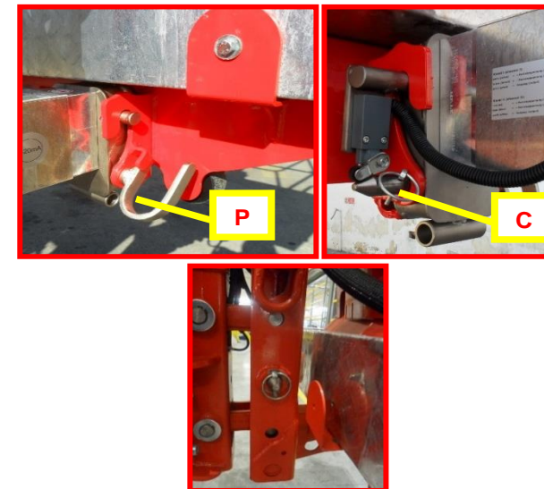
Figure 50 : assemblage de la nacelle.
