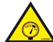
Figure 110 : danger de haute pression.
