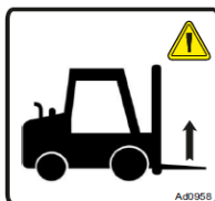
Figure 73 : indication des points d'enfourchement.
