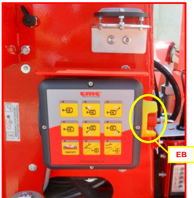
Figure 15 : poste de contrôle stabilisateurs.
