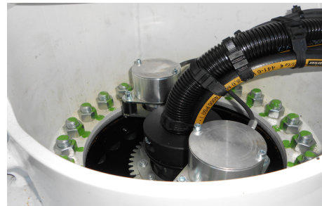
fig. 2.10.8 Capteurs de rotation
