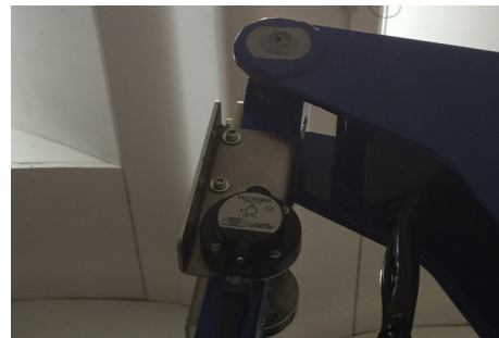
fig. 2.10.9 Trasduttori d'angolo jib
