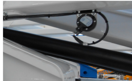
fig. 2.10.7 Transducteurs d'angle pantographe
