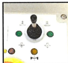
Commande de stabilisateur dans le panier
