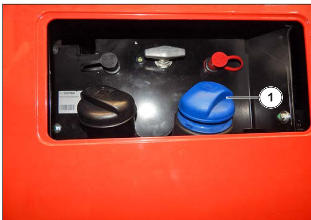
Figure 122: Remplissage du réservoir de DEF
