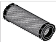
CARTOUCHE DU FILTRE A AIR SEC Référence: 227959 Nettoyer: 50 H Remplacer: 400 H
