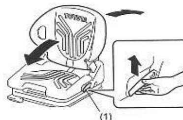
(1) Levier de réglage d'inclinaison du dossier
